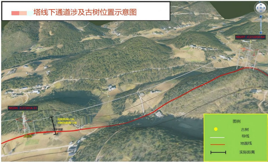
图 4 某塔位线下通道及古树位置示意图
