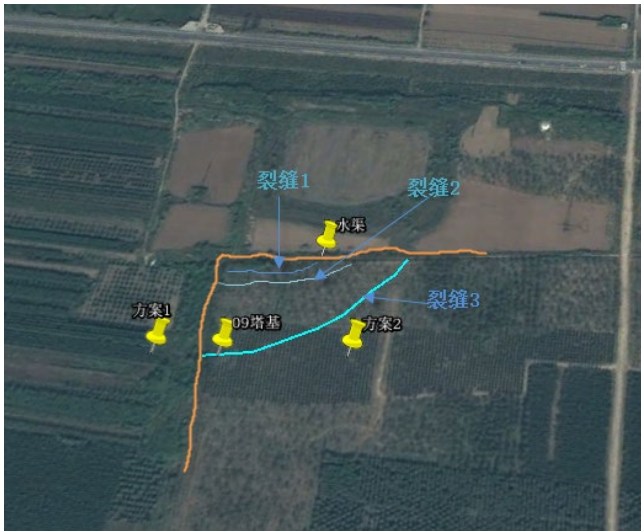
图 6 黄土场地湿陷和裂缝
